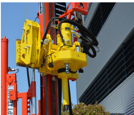
Testa di rotazione con martello a percussione Rotary head with hydraulic hammer Tête de rotation avec marteaux hydraulique Drehkopf bei hydraulii hhammer Cabeza de rotación con Martillo Hidráulico Головка вращения с ударным молотом
