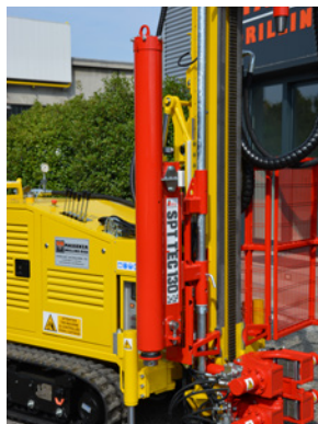
Penetrometro SPT SPT penetrometer Pénétrómetro SPT SPT penetrationsmesser Penetrometro SPT Пенетрометр SPT
