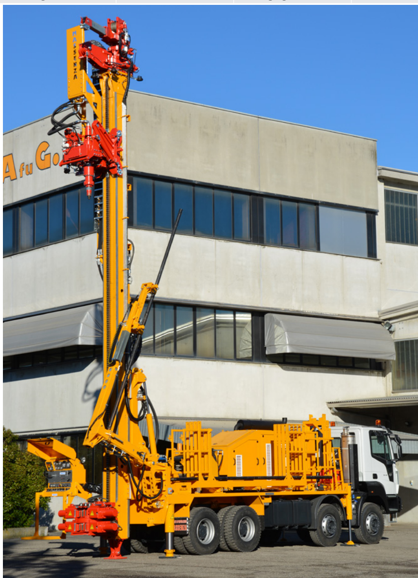
Caricatore aste con braccio Pipe loader with arm Chargeur de tiges avec bras Bohrgestänge-lader mit arm Cargador de barras con brazo Манипулятор подачи штанг
